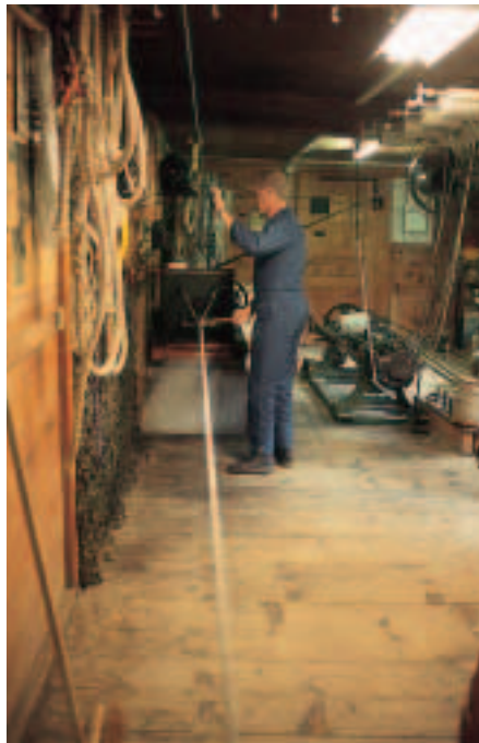
Das Seil ist fertig gestellt und die Ver-seilmaschine wird abgeschaltet
