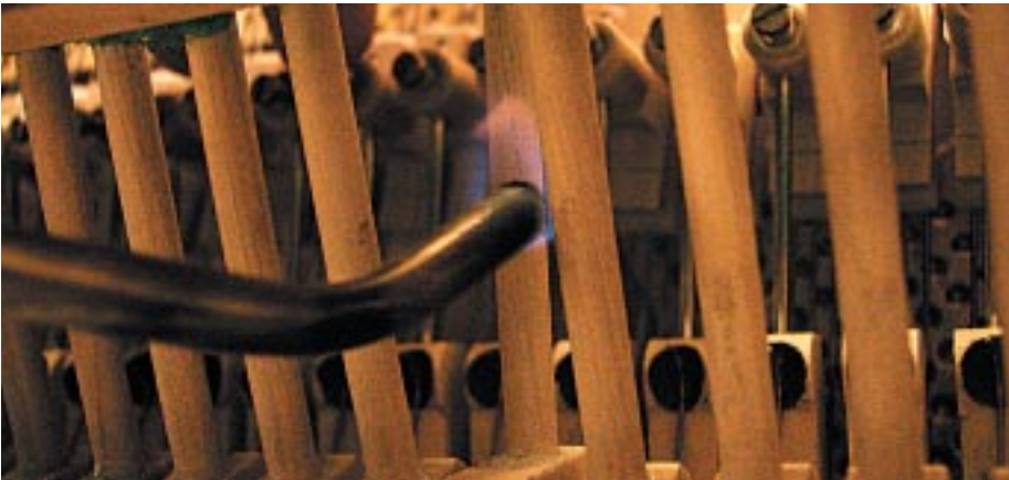
Regulieren – Hammerstiele brennen
