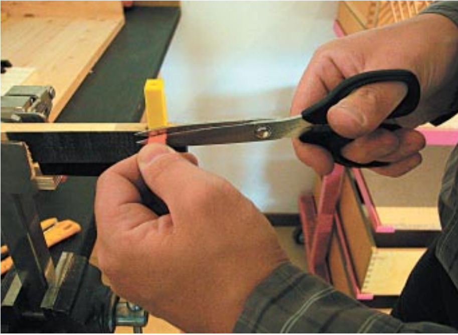
Neugarnieren der Klaviatur mit Kaschmirtuch
